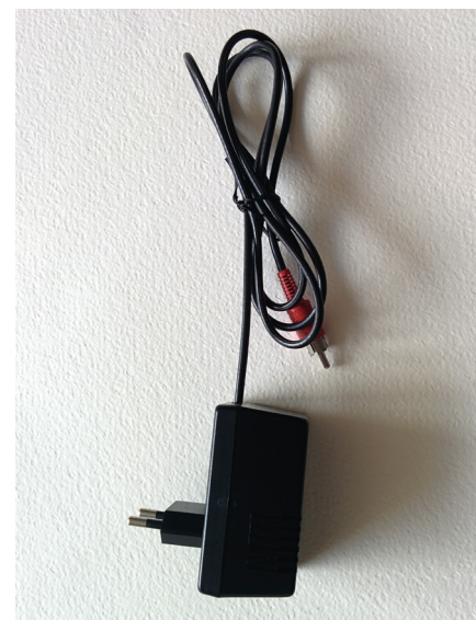
Napajalni transformator (TR1) digitalne ure
