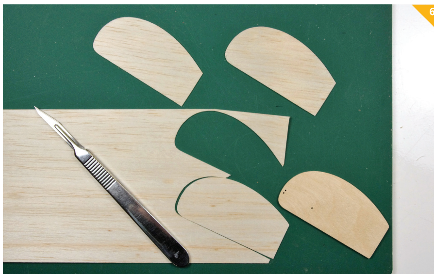
Pri izrezovanju kril in krakov propelerjev si pomagamo s šablonami.
