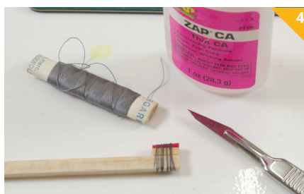
Končna pritrnitev ležaja z več ovoji sukanca in cianoakrilatnim lepilom
