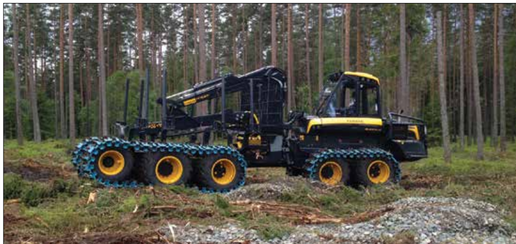
Slika 2: Prototipna, desetkolesna izvedba zgibnega polprikoličarja (foto: M. Mihelič)
