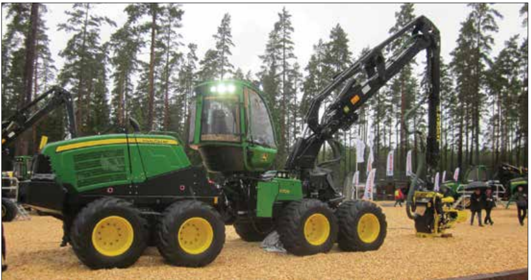
Slika 1: Novost: Osem kolesni stroj za sečnjo (foto: J. Marenče)
