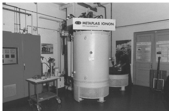
METAPLAS IONON HZIW 600/1000 peč za nitriranje v pulzirajoči plazmi
