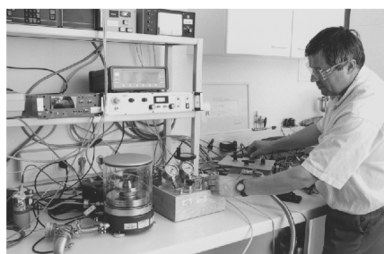
Tlačna tehnika RUSKA 2465A za kalibracije merilnikov tlaka
