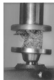
Določanje tlačne trdnosti na preizkušancu iz kamna
