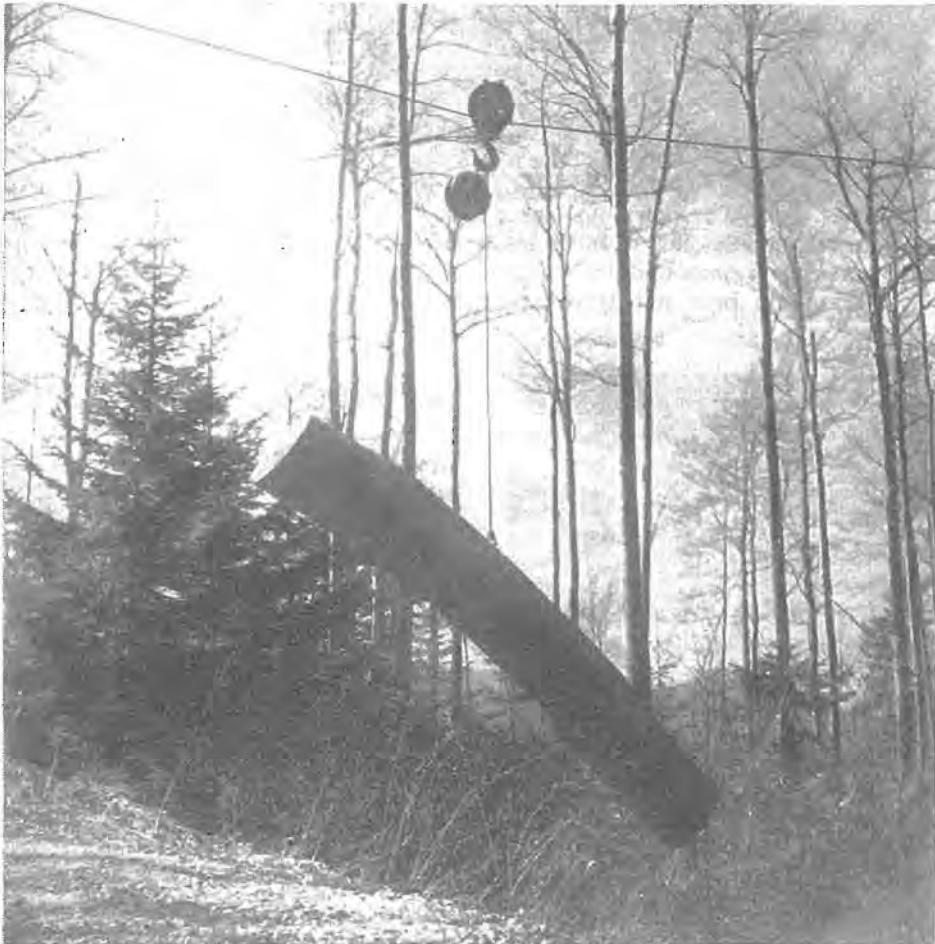
Z napenjanjem nosilne vrvi, navite na prvi boben, dvignemo breme s tal in ga tako pripravimo za izvlek, ki ga bomo opravili z navijanjem vlačilne vrvi na drugi boben (foto: Kordiš)
