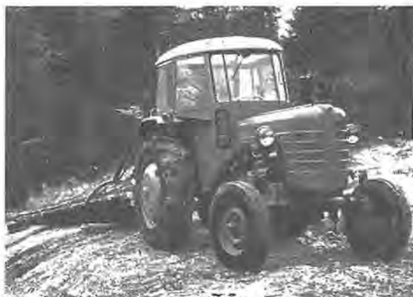
Sl. 4. Nosilni drog z vitlom kot priključek traktorja za spravilo tovara s tankimi debli
