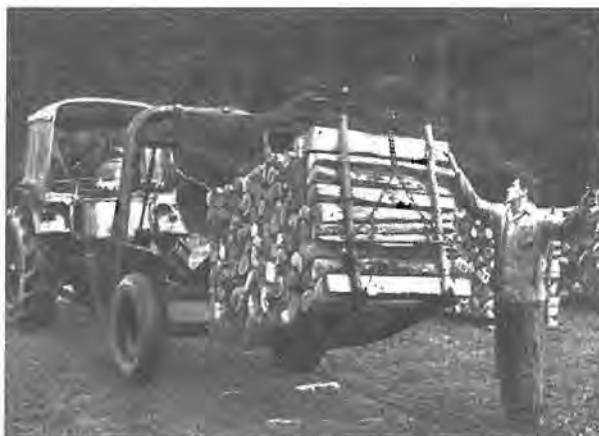
Sl. 8. Nakladanje palete celuloznega lesa na fraktorsko prikolico
