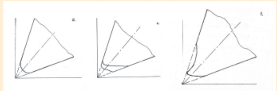
□ Slika 5def. Shematski prikaz profila izrabe konice rezila
