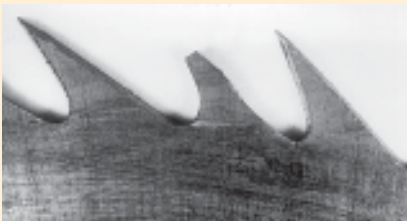
□ Slika 3. Zelo tanek vrh rezila orodja
