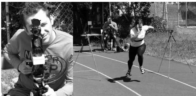
Slika 6: Laserska metoda merjenja sprinterske hitrosti
