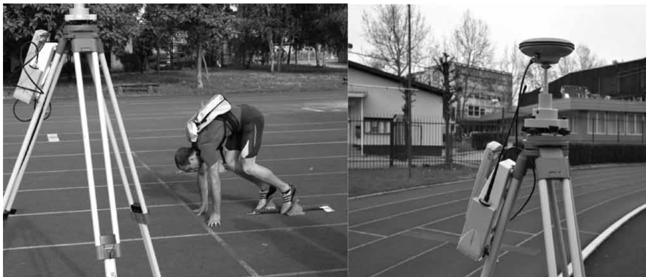
Slika 9: Satelitski navigacijski sistem je mogoče uporabiti tudi pri meritvah hitrosti sprinterjev.
