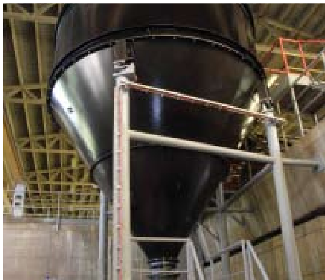
Novi zalogovnik s transportnim polžem in tehtalnimi celicami
