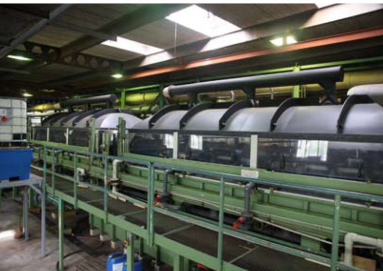
Proizvodna linija za elektrokemijsko obdelavo aluminija
