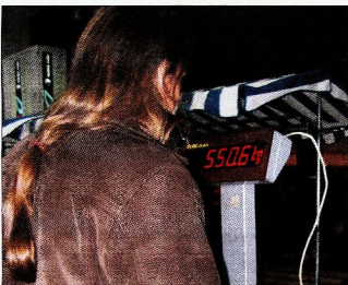
Sila, ki se sprosti ob trku v oviro se s povečevanjem hitrosti izredno povečuje. Tehnice prikazujejo silo, ki delujejo pri trku s hitrostjo 30, 50 in 90 km/h. Tudi te so med proizkusiti.
