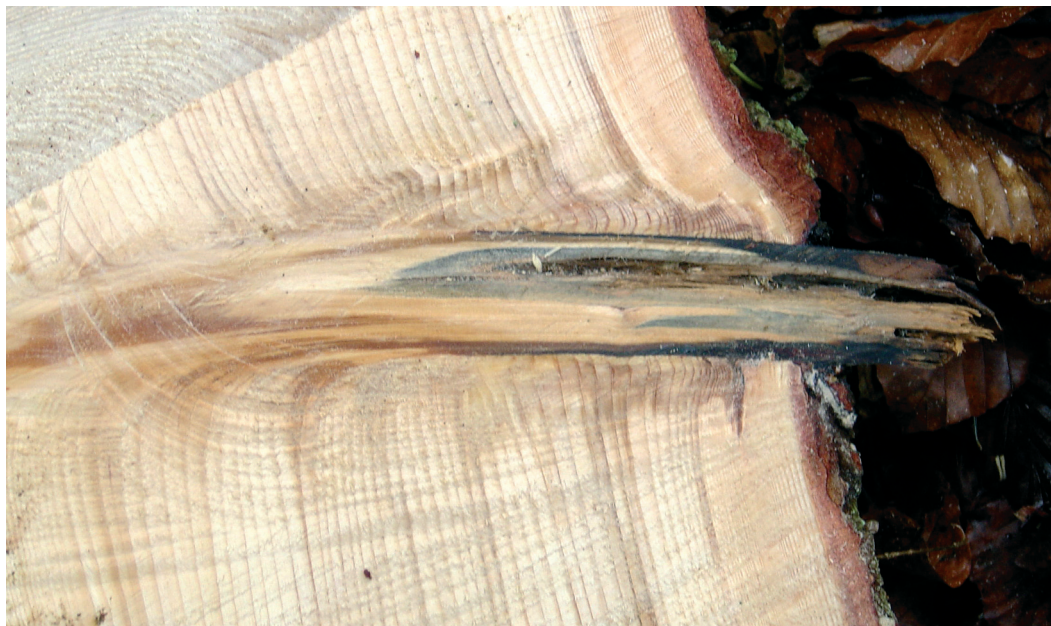
Slika 11: Odmrli del veje je »predrl« beljavo: voda penetrira v suho jedrovino.
