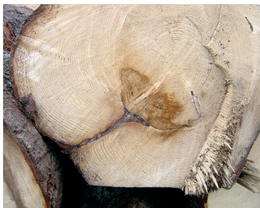
Slika 14: Kolesivost kot posledica stare površinske rane.
