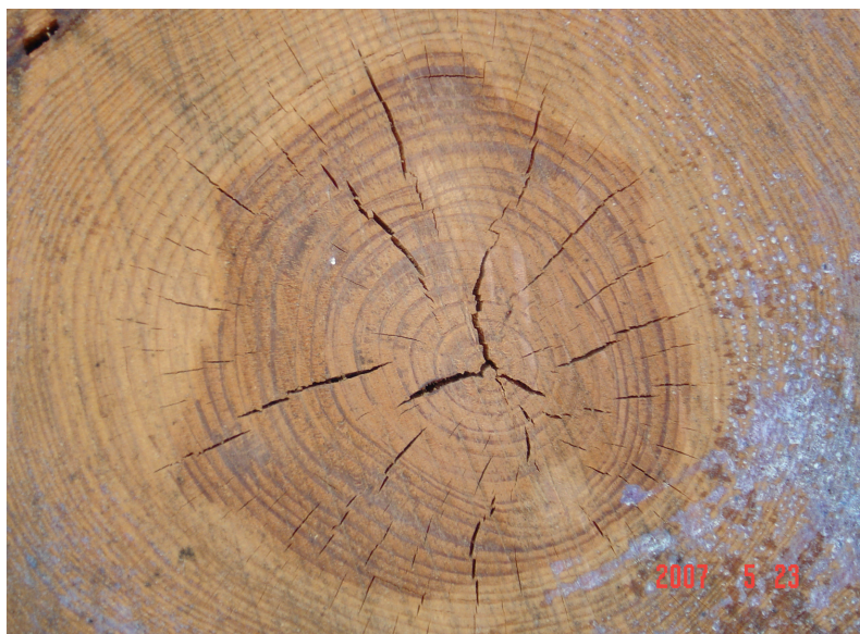
Slika 18: Radialne razpoke le v mokrem srcu.
