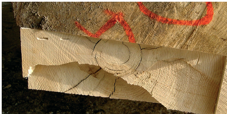
Slika 17: Nagnjenost k pokanju – najhujša napaka jelovine.
