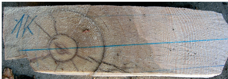
Slika 15: Popolna izvotlitev debla zaradi velike površinske poškodbe (CODIT): strohnel je ves les, ki je nastal pred poškodovanjem.
