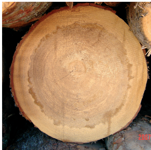
Slika 8: Jedrovinsko mokro srce tekoče prodira za abscisijsko suho cono; mestoma »rožički« beljavskega mokrega srca.
