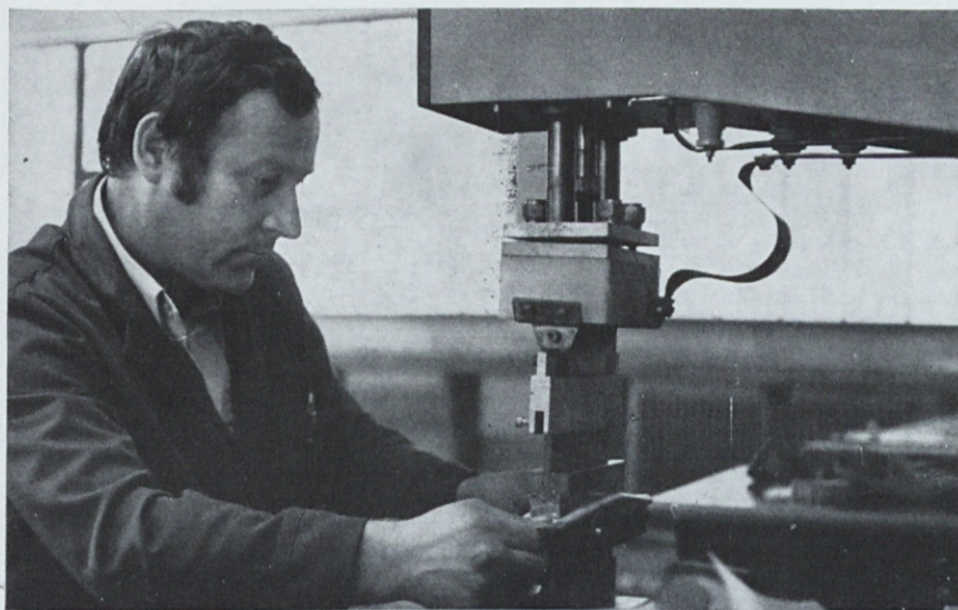
Mojster Janez Hafner pri varilnem stroju VF 3 preizkuša in pripravlja material za izdelovanje prezračevalnih cevi za rudnike
