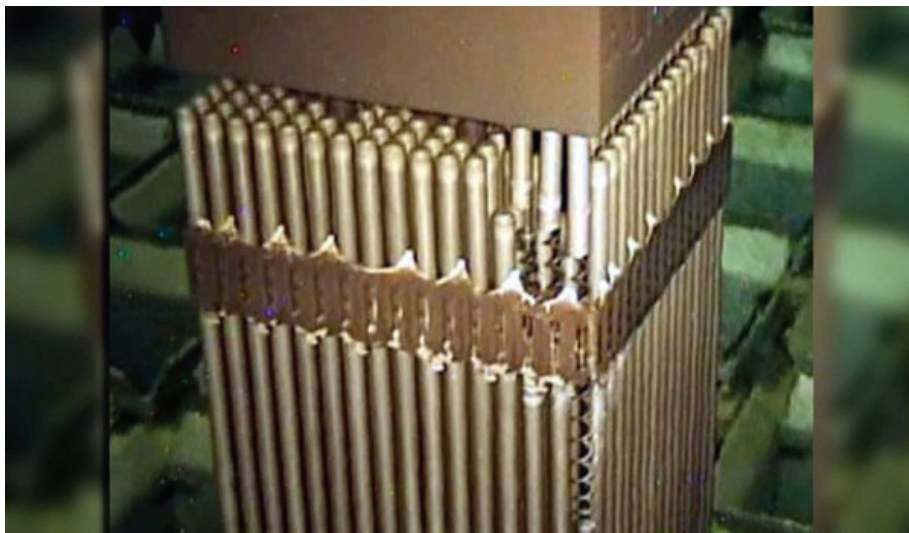
Slika 13: Poškodovani gorivni element AD11 (Foto: Kanal A)
