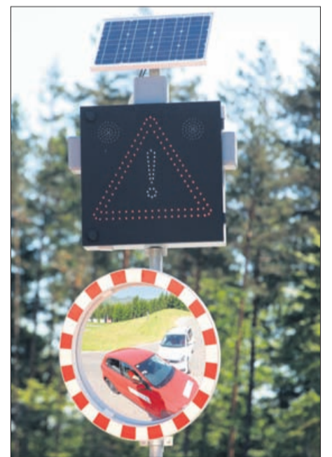
Opozorilni detektor mrtvega kota je ponavadi nameščen na že obstoječe prometno ogledalo, deluje na sončno energijo.
