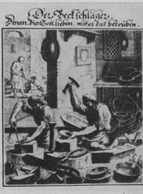
Upodobitev izdelovanja medeninastih kotličev, Iz: Peltzer: Geschichte der Messingindustrie
