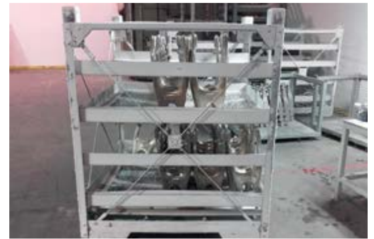
Vilice čakajo na ravnanje po termični obdelavi.
