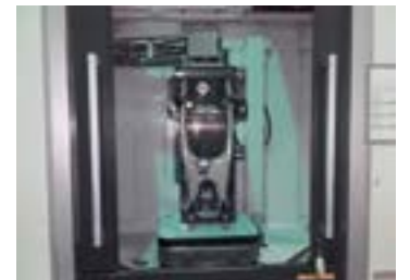
Vilice med obdelavo na CNC-obdelovalnem centru
