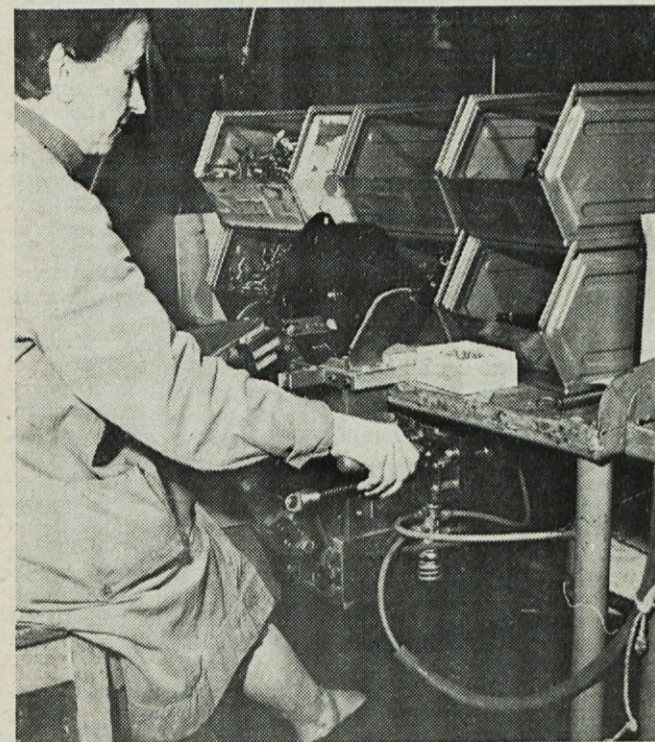
Doma izdelana naprava na zrak za kovičenje žarometov v montaži OTP in Marija Andročec ob njej
