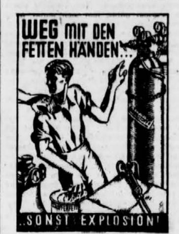
Als eine wichtige Bedienungsanweisung für Schweißapparate hat daher zu gelten: Öl und Fett von der Sauerstoffflasche fernhalten, denn der bei undichten Stellen austretende hochgespannte Sauerstoff zerlegt die organischen Bestandteile und die auftretende Reibung gibt Anlaß zu der überwühlten Entzündung und Explosion.
