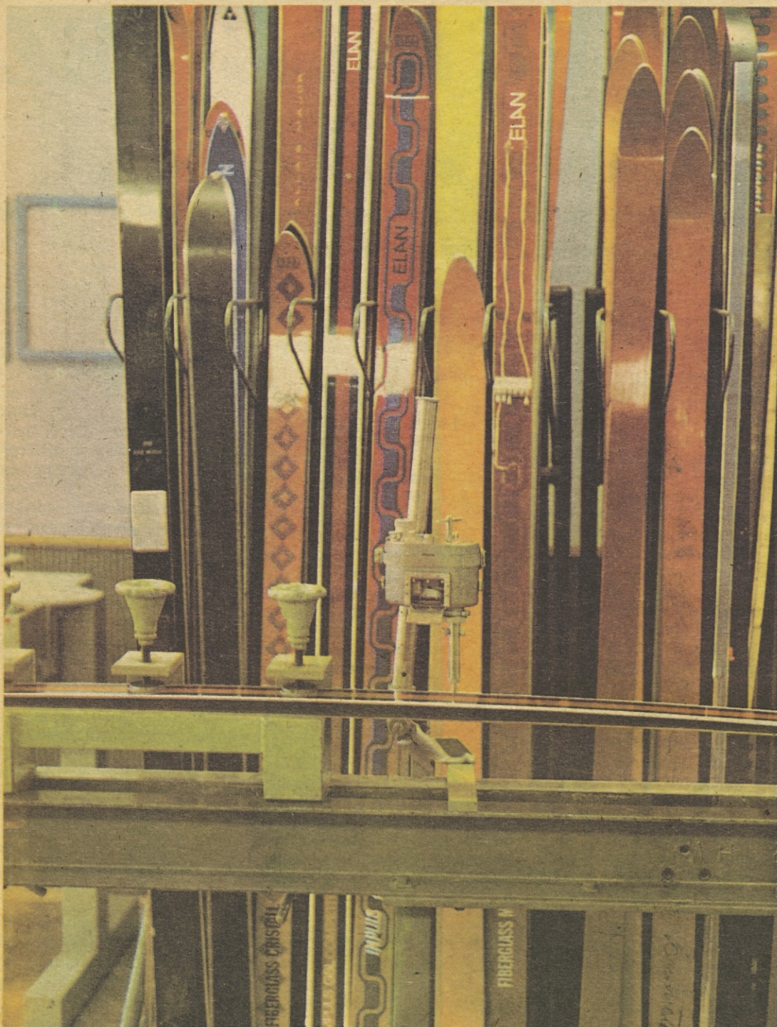
Inštitut tovarne ELAN razpolaga med drugim tudi z aparatom za meritev frekvence in časa „iznihanja“ smučí. (Foto: A. Ul.)
