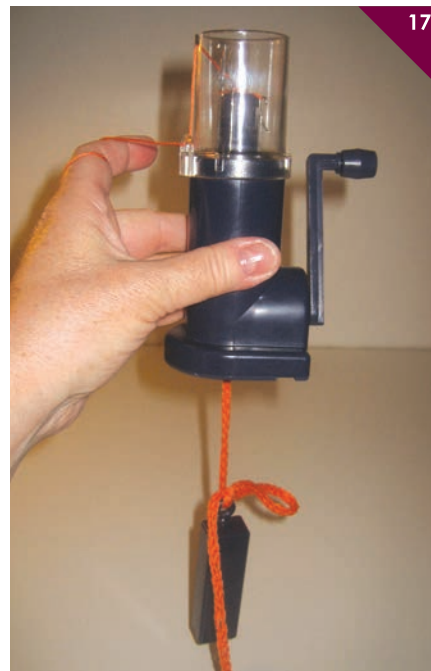
17 Pletena vrvice nastaja z vrtenjem ročke, ki sproži dviganje pletilnih igel, zajemanje niti in pletenje zank.
