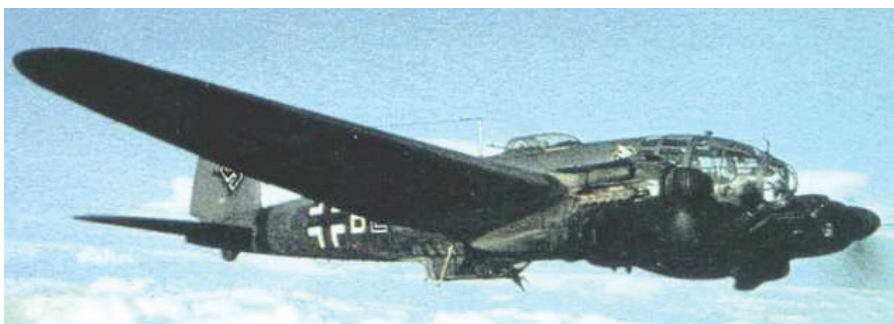
Zgodnji He 111H-6 iz sestava KG 53 v letu; sprednji trebušni položaj je opremljen z 20-mm topom.
