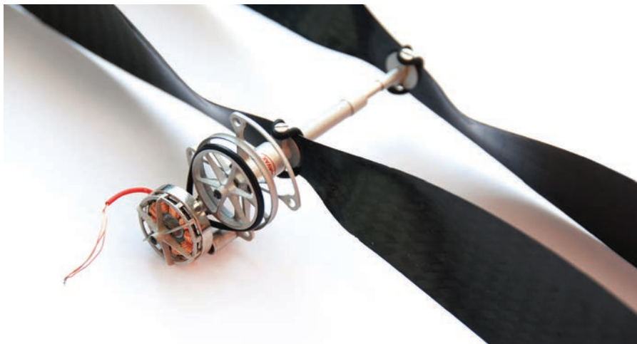
Nasprotno vrteči se pogon SG-Glavak SG-CRE 02
