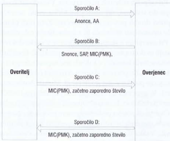
Slika 9: Štirismerni protokol za overjanje in izmenjavo začasnih ključev
