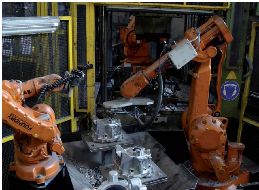
Slika 3: Robotizirana celica za odstranjevanje srha aluminijastih ulitkov
