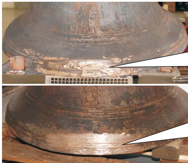
Slika 5: Prikaz dela zvona z varom takoj po varjenju (zgoraj) in sanirani zvon po brušenju vara (spodaj)
