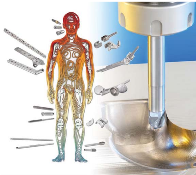
Medicinski vsadki zahtevajo zelo zmogljive obdelovalne stroje, npr. pri rezkanju umetnih kolenskih sklepov in kolčkov s trdokovinskimi orodji (vir: Iscar).
