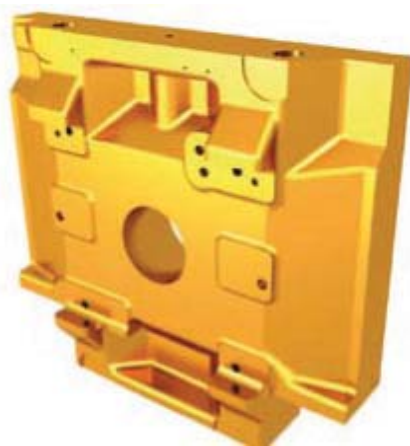
Slika 1: Zapiralna plošča je izdelana tako, da so premikajoče se mase čim manjše. Ker je Englova plošča podprta v sredini in ne v kotih (vodila), je »dihanje« orodja veliko manjše.
