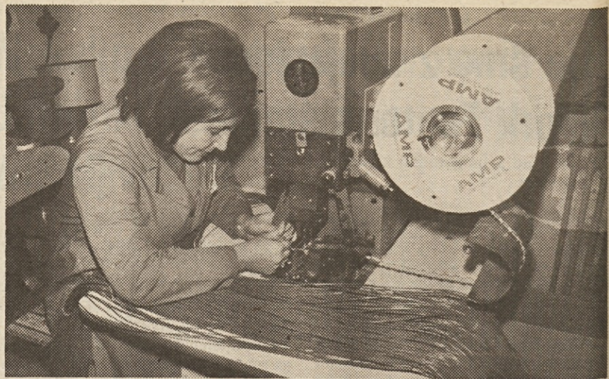
Natalija Radojčić ob stroju za stiskanje spojk za vodnike.
