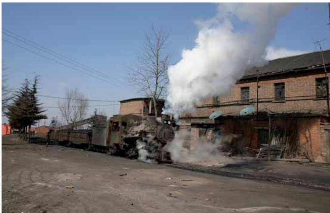
Premogovnik Ying Hao, 4. marca 2005. Lokomotiva vrste 0-8-0 vleče iz premogovnika krajši vlak, naložen s premogom, na izmenjevalni industrijski tir Kitajskih železnic. Vlaki so kratki zaradi ostrega naklona izven premogovniškega dvorišča. Na tej progi še vozijo s parno vleko.
