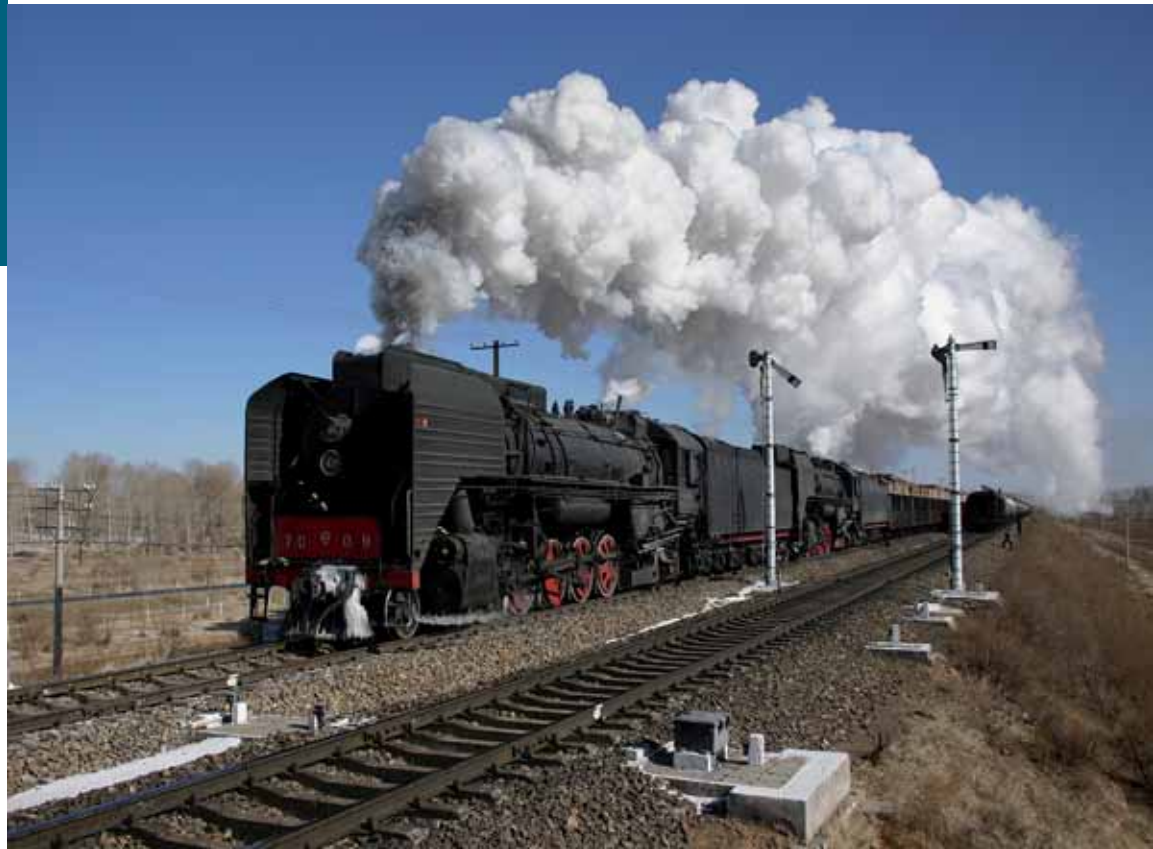
Posnetek je bil posnet 21. februarja 2005. Lokomotiva vrste QJ št. 7009 vodi sestrsko lokomotivo v tovornem vlak po znani progi Ji-Tong le mesec dni preden so ukinili redne vožnje vlakov na parno vleko. Pozor na led na sprednji spojnici. Ob progi so vgrajeni semaforški signali.
