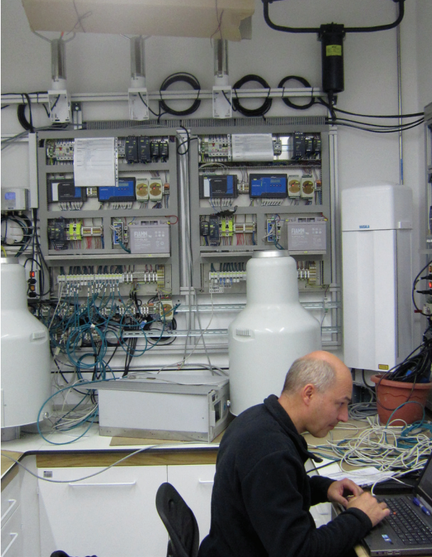
Slika 4. Del infrastrukture v laboratoriju za sestavljanje, popravljanje in preizkušanje samodejnih merilnih postaj. (vir: ARSO)
