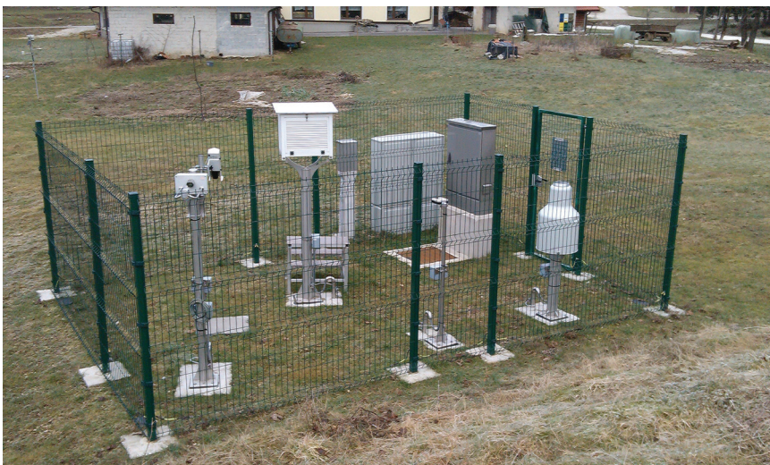
Slika 7. Značilna postavitev merilnih naprav na Bobrovi meteorološki postaji – v Zadlogu, kjer poleg padavin merimo še temperaturo zraka na 2 m, vlažnost zraka na 2 m ter globalno in difuzno sončno obsevanje. (vir: ARSO)
