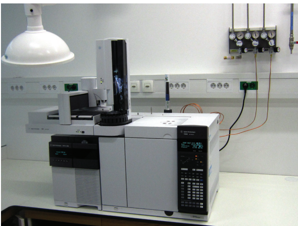
Slika 17. Plinski kromatograf z masno selektivnim detektorjem uporabljamo za določitev PAH (polcikličnih aromatskih ogljikovodikov) v padavinah in delcih PM. (vir: ARSO)
