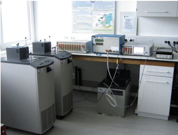
Slika 14. Naprave za umerjanje instrumentov za merjenje temperature. (vir: ARSO)
