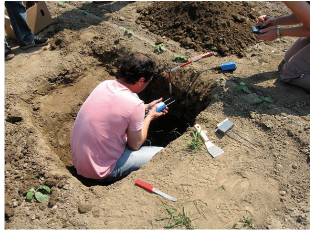
Slika 2. Osnovni gradnik Slovenskega agrometeorološkega informacijskega sistema je meteorološka merilna mreža opremljena tudi z meritvami vode v tleh in podatki o vodnozadrževalnih lastnostih tal. Meritve so nujno potrebne za preverjanje vodnobilančnih modelskih rezultatov. (Foto.: A. Sušnik)
