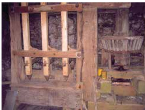
131. Stope v Kovtrovem mlinu (Zloženska razstave Voda teče, mlini meljejo, žage pojo, 2007).
