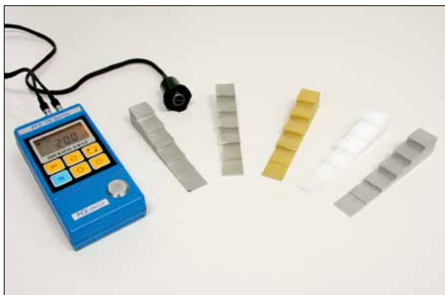
Slika 3. Kalibracija merilnika debeline na etalonih iz različnih materialov in različnih debelin
