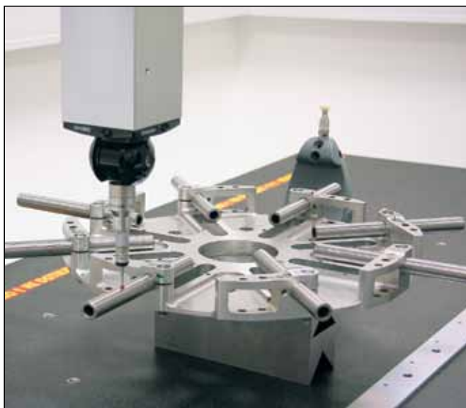
Slika 5. Meritev pravilnosti izvrtin (pravokotnost, vzporednost, ...) na triosnem merilnem stroju
