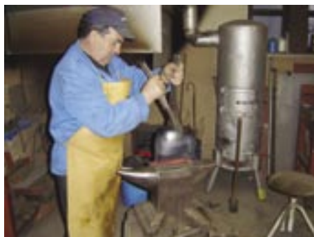
Pločevino, ko jo vzamemo iz žerjavice, hitro upognemo
