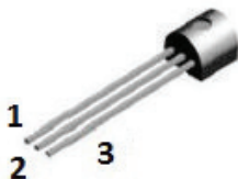
Priključki napetostnega regulatorja LM78L05 (1 – vhod, 2 – GND, 3 – izhod)
