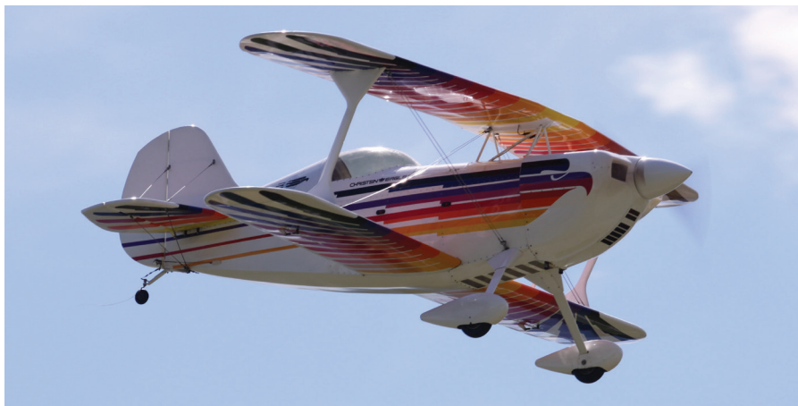
Christen eagle I. med izvajanjem akrobatskega programa. Maketa je v merilu 1 : 2, ima razpnetino kril 303 cm in maso 23 kg, poganja pa jo 190 cm 3 bencinski letalski motor.
