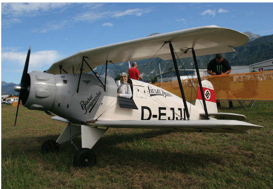
Velikanska maketa bücker jungmeistra na razstavnem prostoru. Maketa ima razpetino kril 4 m, tehta kar 63 kg, poganja pa jo zvezdast bencinski motor.
