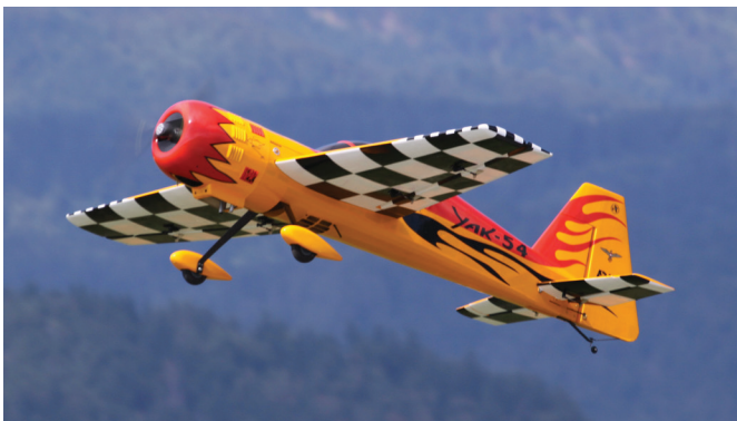
Jak-54 avstrijskega tekmovalca Kevina Seinerja ob vzletu. Model ima razpetino 2,70 m in maso 16 kg, poganja pa ga motor 110 cm 3 .
