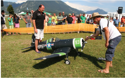
Wolfgang Rossegger vžiga motor na maketi znanega lovskega letala iz druge svetovne vojne corsair. Maketa je izdelana v merilu 1 : 4, ima razpetino kril 3,10 m in težo kar 31 kg, poganja pa jo zvezdast motor.
