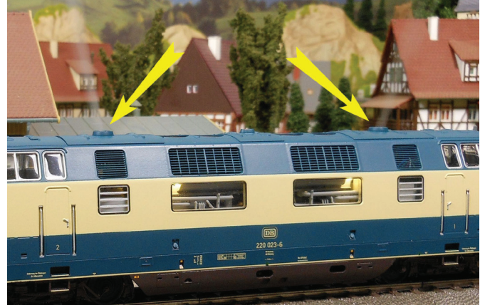
Pri zagonu zvokov dizelskih motorjev se skladno z zvokom prvega motorja najprej pokadi iz ene izpušne cevi, ko pa zahrumi drugi motor, se pokadi še iz druge izpušne cevi.
