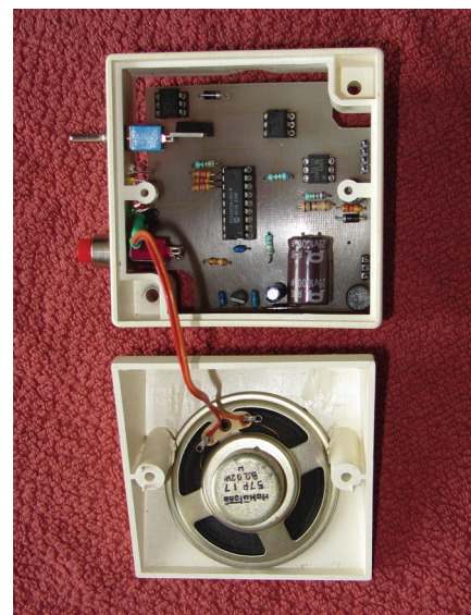
Elektronika za daljinsko odpiranje vhodnih vrat
