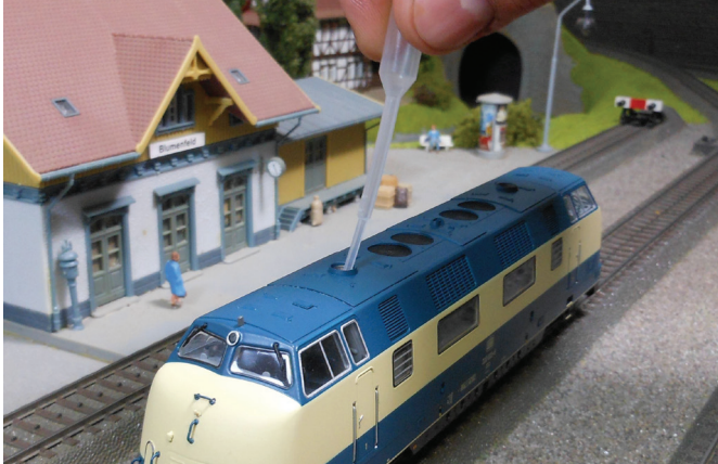
Dimni generator s pomočjo majhne pipete polnimo z ESU-jevim destilatом skozi izpušno cev na zgornji strani modela. Med polnjenjem mora biti model v vodoravnem položaju, količina destilata pa ne sme presežati 0,5 ml.
