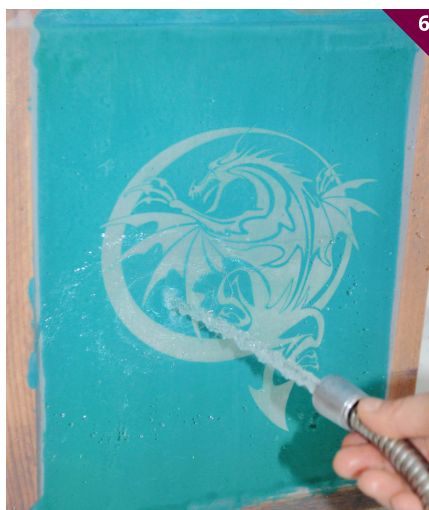
Izpiranje fotoemulzije z osvetljenih delov sita
