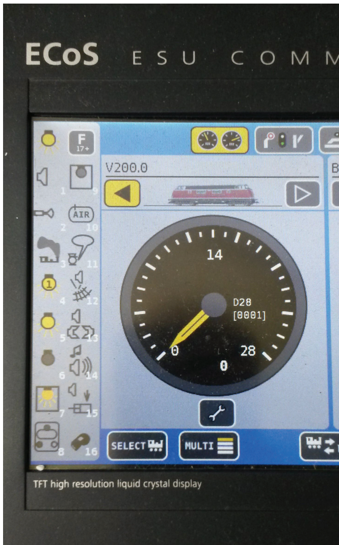
ESU-jeva digitalna centrala ECoS 50200 zazna model dizelsko-hidravlične lokomotive DB 220-023-6 in avtomatsko izpiše vse funkcije, shranjene v serijsko vgrajenem dekodirniku LokSound V4.0 M4.
