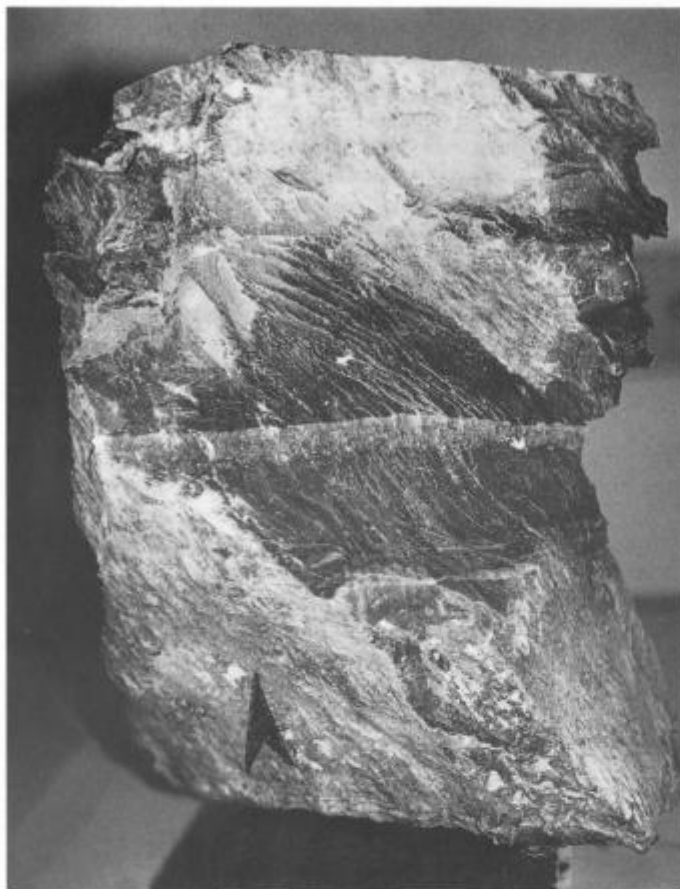
Sl. 1. Diferencialni klivaž, ki je nastal na prehodu med glinastim skrilavcem in lamino meljastega peščenjaka. Puščica kaže zaglinjeno drsno površino v smeri skrilavosti. Predor Golovec, pomanjšano 3 x.
