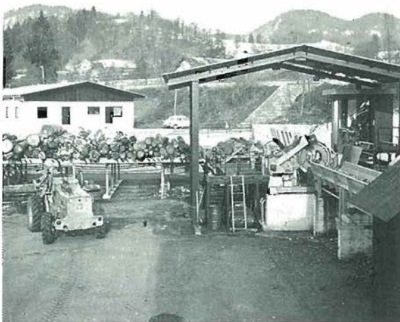
Vhodni, sprejemno-podajalni transporter z lupilnim strojem centralnega mehaniziranega skladišča na Rečici pri Bledu. V ozadju pomožna stavba za delavce in za priročno delavnico
