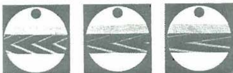
Sl. 2. Odklon od vodoravnice nakazujejo na merilni napravi redkejše (manjši odklon) ali gostejše (večji odklon) puščice, vzporednih črt ni več
