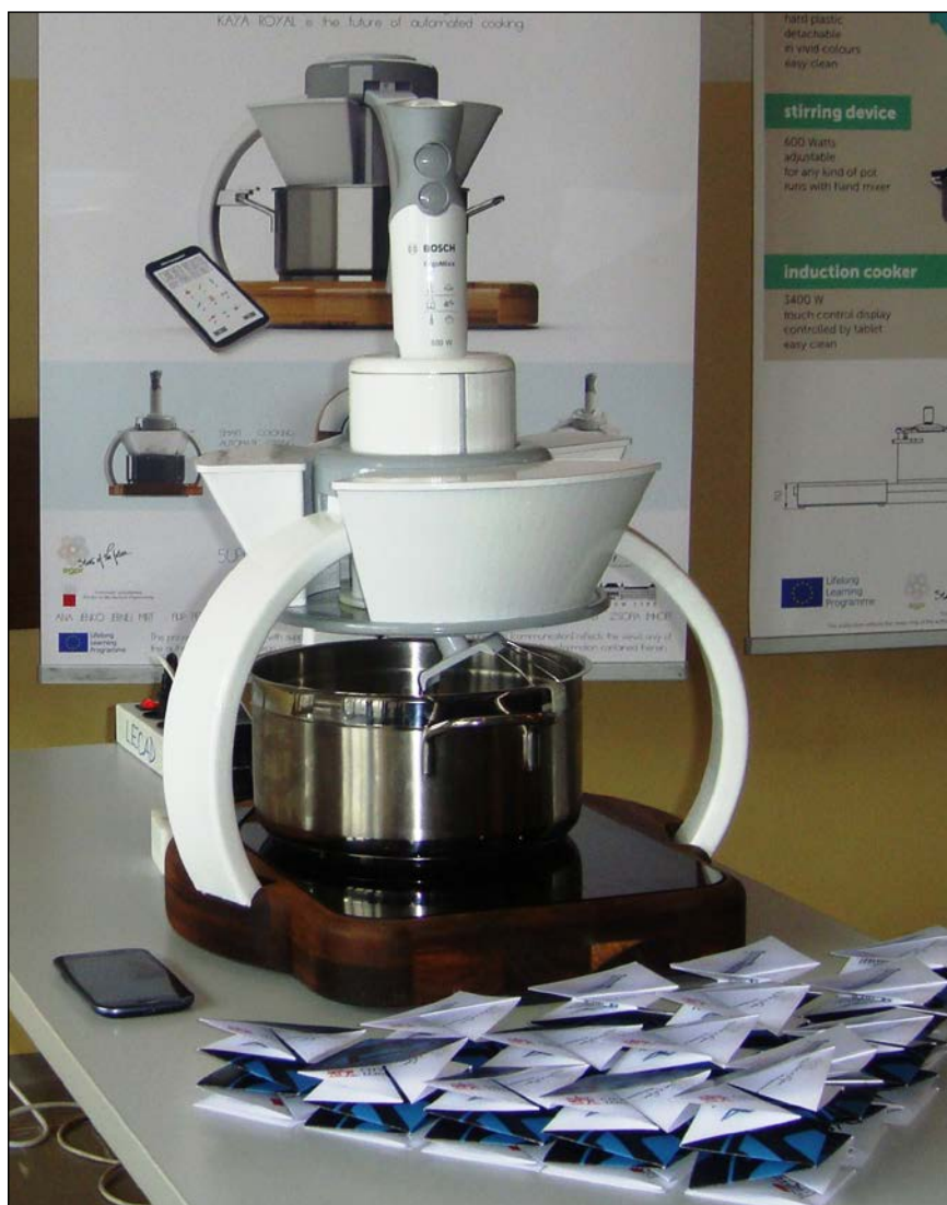
Futuristična kuhhalno mešalna naprava z avtomatiziranim podajanjem sestavin in pripravo hrane
