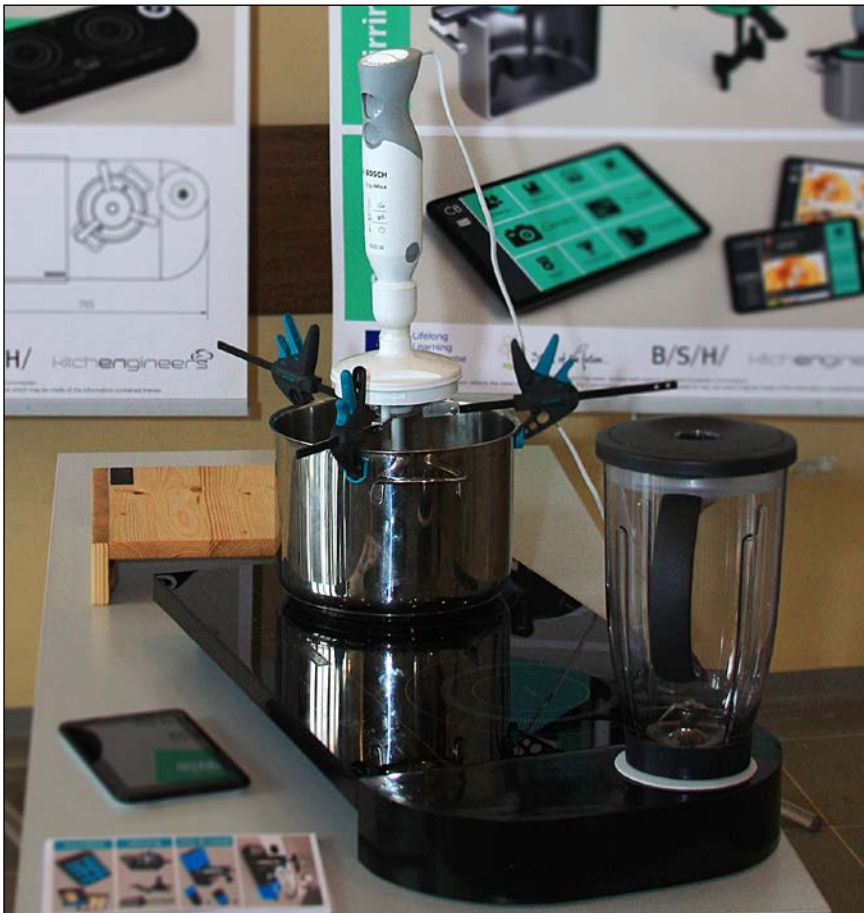
Namizna kuhinja v enem, ki združuje pripravljalno desko, dve grelni površini in univerzalni mešalni modul. Vsi elementi so povezani tudi z digitalno uporabniško izkušnjo preko mobilne naprave.
