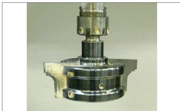
Slika 2. Rezkalna glava z 2 reziloma iz karbidne trdnine
