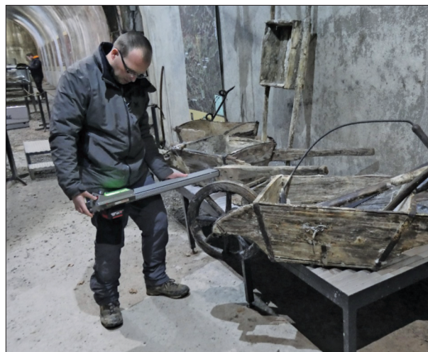
Slika 3. Izvedba meritev razkrojenosti lesa z napravo Resistograph IML PD500.
