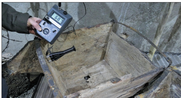
Slika 2. Izvedba meritev vlažnosti lesa z vlagomerom GANN.
