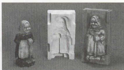
Za dvodelne reliefne kalupe je primeren nizkoviskozni kavčuk NV, ki natančno posname tudi najmanjše podrobnosti.
