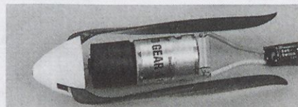
Slika 11. Najboljša rešitev za jadralna letala z razpetino do dveh metrov: prenos 4 : 1 in vijak cam gear prop.
