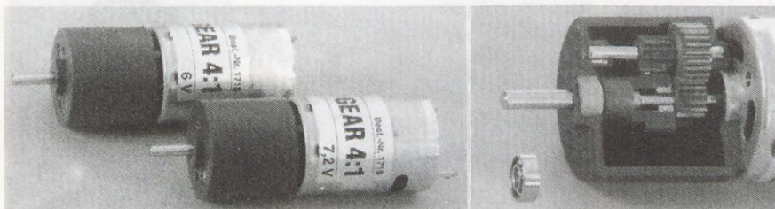
Slika 5. Zobniški prenos motorja 400 firme Graupner
