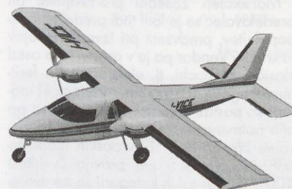
Slika 13. Partenavia victor je lep dvomotorni model s pogonom na dva elektromotorja speed 400.
