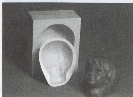
Gostejši kavčuk HV je primeren za nanašanje na navpične ploskve. Uporablja se lahko tudi v kombinaciji s cenejšimi materiali, n. pr. mavcem.
