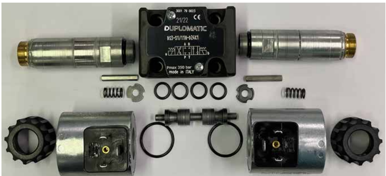
Slika 3 : Razstavljen testirani ventil DS3-S1/11N-D24K1
