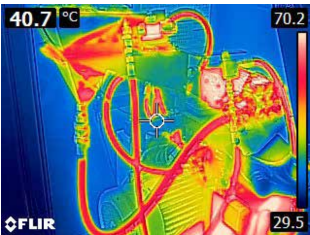
Slika 7 : Toplotne razmere na hidravličnem preizkuševališču med testiranjem
