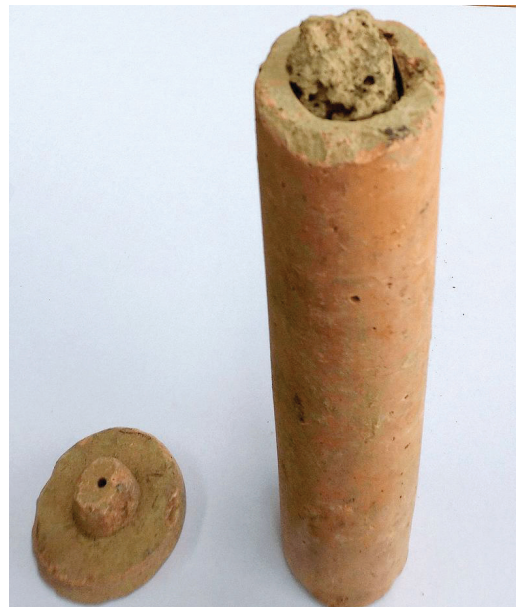
Slika 2b: Primer originalne podzemne poligonske točke iz časov novih izmer v Prekmurju pred letom 1974. Foto: avtor.
