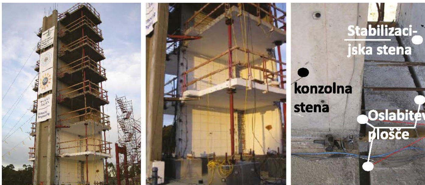
Slika 4 • Konzolna armiranobetonska stena, preizkušena na potresni mizi na UCSD.
