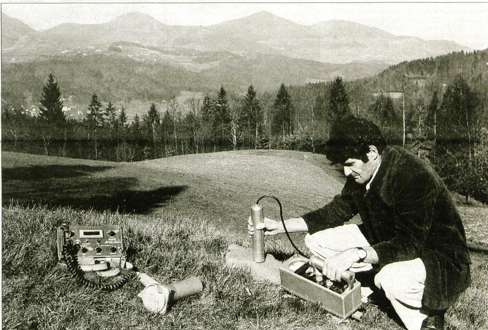
Avtor pri meritvah naravne radioaktivnosti na mestu prve globoke strukturne vrtnine B-1; ta je leta 1961 navrtala bogato rudo na obzorju 580 m, kjer se je razvila zgornja jama. Posneto leta 1977 nad kmetijo Jurka. Na obzorju Koprivnik, Mladi in Stari vrh.
