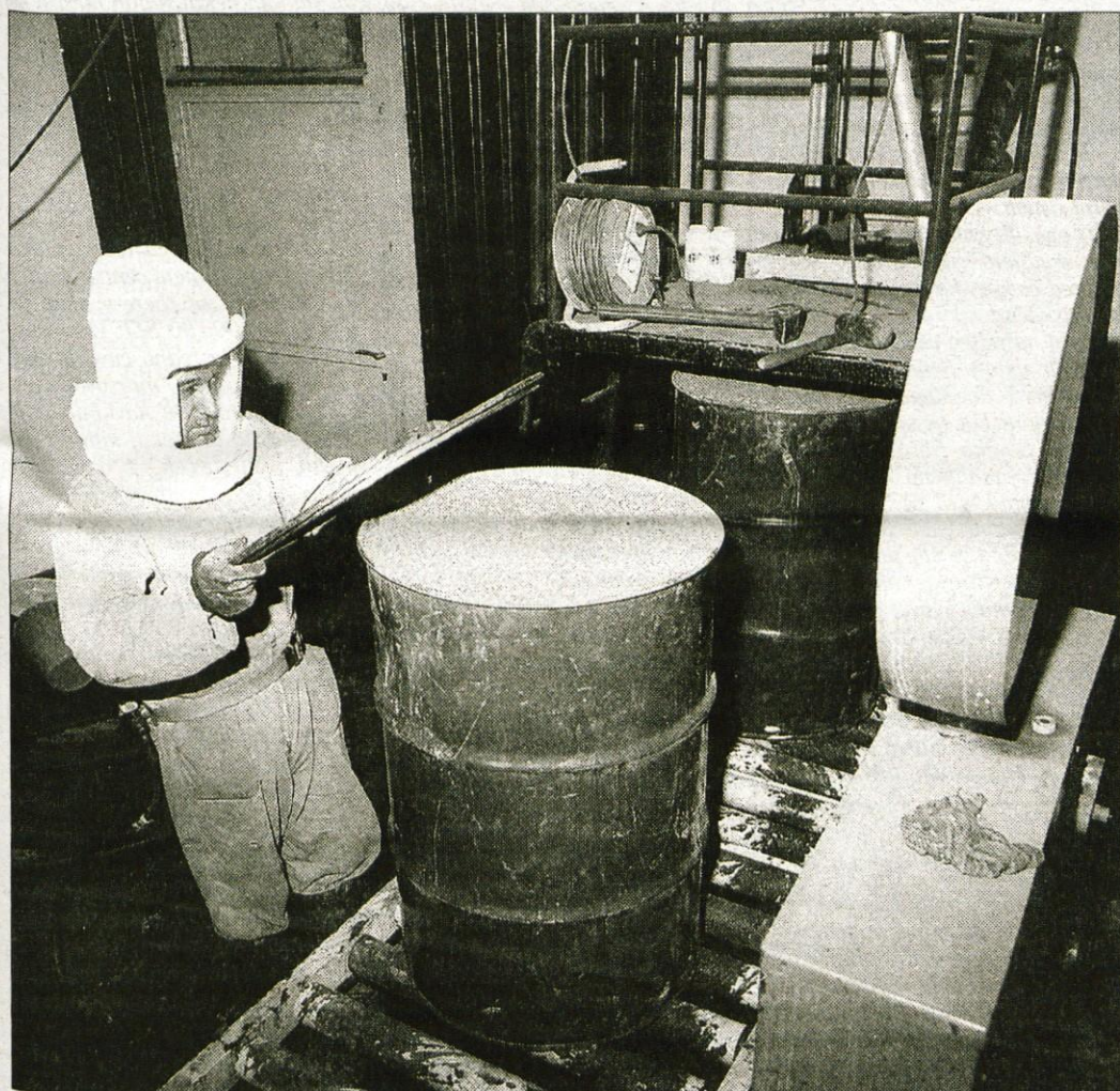
Polnjenje sode z uranovim koncentratom. V RUŽV je bilo iz 633.000 ton rude pridobljeno 452 ton uranovega oksida v koncentratu. Odposlan je bil v bogatenje v Veliko Britanijo, Francijo in Združene države Amerike.
