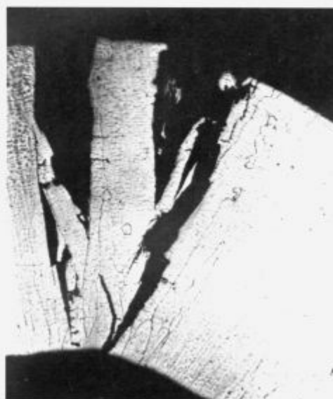
Slika 9. Napetostno korozijsko pokanje na vzorcu 1.10 ima interkristalni, mestoma tudi transkristalni karakter; pov. 50x.
