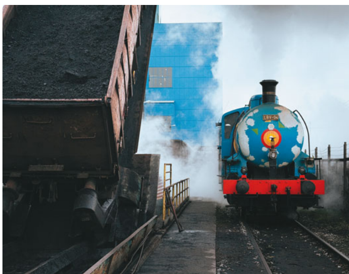
Premik v TE-TOL, kjer imajo pare v izobilju, opravlja parna akumulatorska lokomotiva LBV04, izdelana v tovarni Đuro Đaković.
