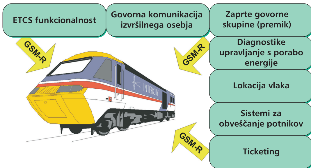
Shema 2: Možnosti uporabe sistema GSM-R
