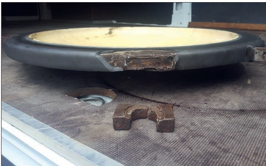
Slika 4. Odtrgano uho na pokrovu pri tlačnem preskusu
