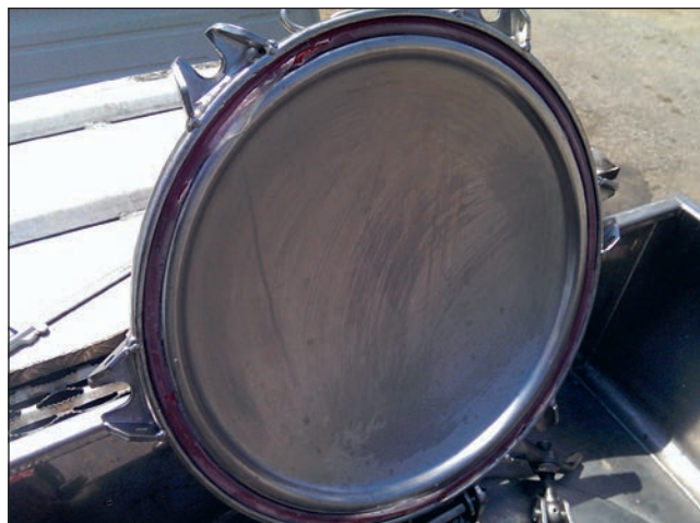
Slika 3. Poškodba tesnila na pokrovu cisterne
