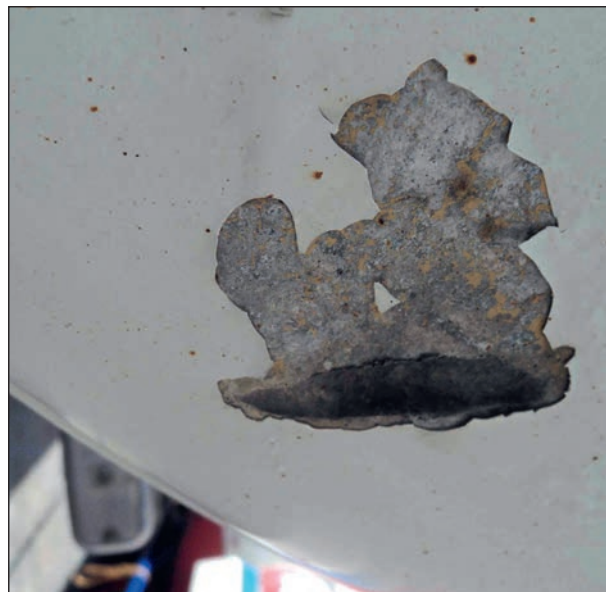
Slika 1. Plastična deformacija na dnu cisterne
