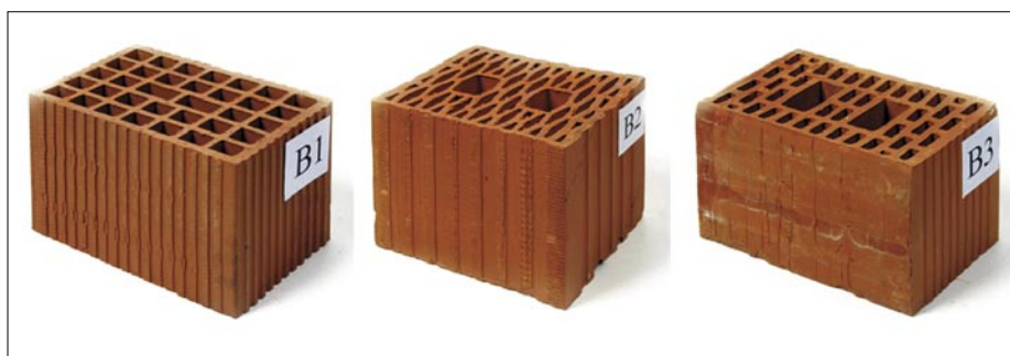
Slika 9 • Zidaki B1, B2 in B3, uporabljeni za zidanje zidov za ciklično preiskavo potresne odpornosti in za preiskavo začetne strižne trdnosti zidovja po SIST EN 1502-3
