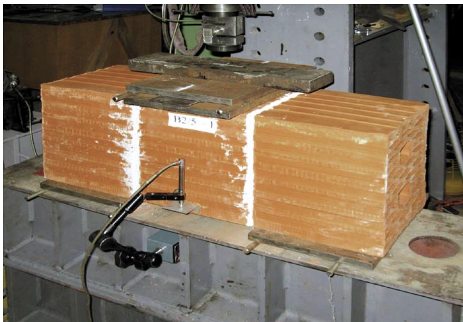
Slika 8 • Preizkus začetne strižne trdnosti zidovja po SIST EN 1502-3 v laboratoriju
