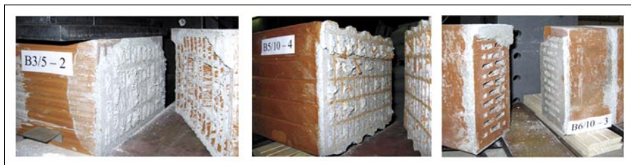
Slika 11 • Tipični primeri porušne ravnine po končanem preizkusu začetne strižne trdnosti zidovja. Preiskave vzorcev iz votlakov B3, B5 in B
