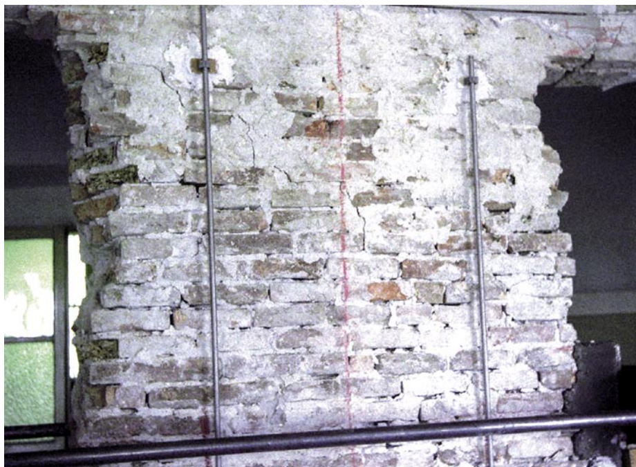
Slika 5 • Preiskava strižne odpornosti opečnega zidu na terenu: pred nastankom strižne razpoke ni opaziti nobene vodoravne natezne razpoke ali drobljenja opeke v tlačnih vogalih (Sheppard in Tomaževič, 1985)
