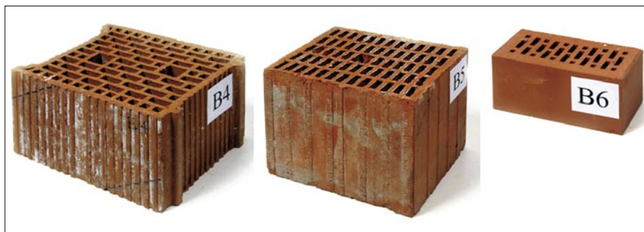
Slika 10 • Zidaki B4, B5 in B6, uporabljeni za zidanje zidov za ciklično preiskavo potresne odpornosti in za preiskavo začetne strižne trdnosti zidovja po SIST EN 1502-3
