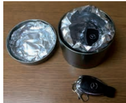
△ Faradayevo kletko za avtomobilске ključe lahko izdelamo tudi sami. Kovinsko posodo obložimo z aluminijasto folijo.
