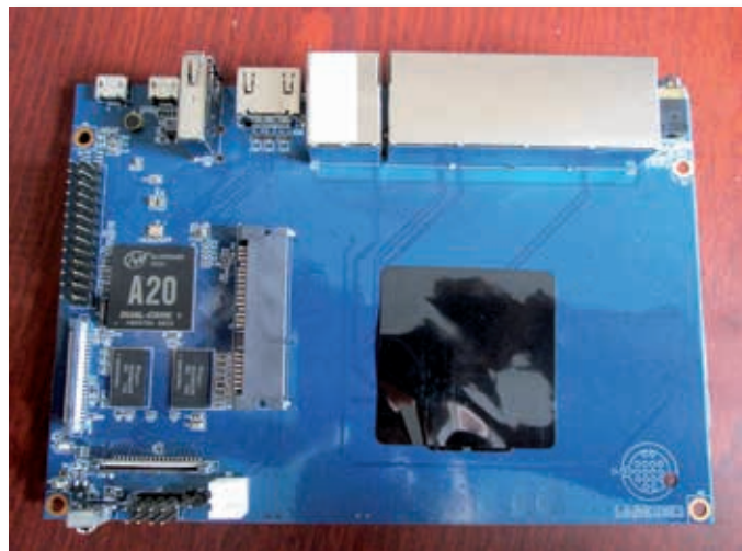
▽ Mikroprocesor A20 na Banana Pi BPI-R1 in z nalepko prekrit del tiskanega vezja, kamor lahko vgradimo SSD ali disk.
