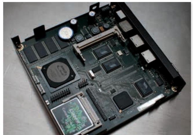
▲ Usmerjevalnik Netgate ALIX med vgradnjo modula Wi-Fi.
