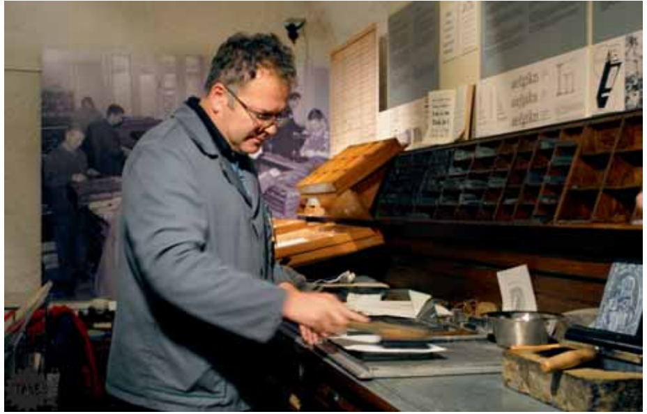
Ročna stavnica s črkovnim gradivom in predstavitev izdelave krtačnega odtisa.
