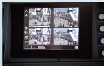
Sodoben videonadzorni sistem, s katerim spremljamo okolico vlaka (foto: Miško Kranjec)
