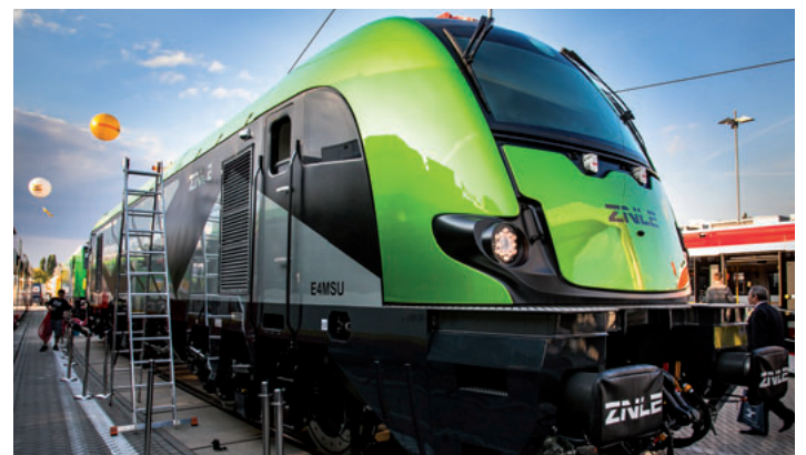
Večsistemna varianta električne lokomotive iz serije Griffin poljskega proizvajalca ZNLE z močjo 5.600 kW. V seriji Griffin je 7 variant za razne sisteme napajanja ter s hitrostmi do 140 km/h oziroma 200 km/h.
