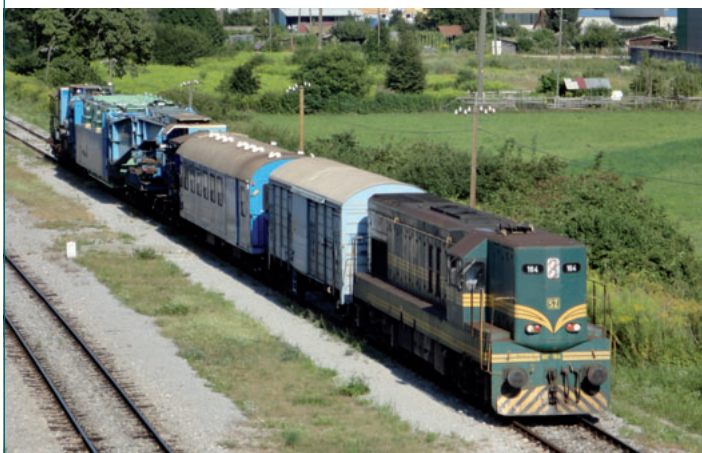
Vleka 502 toni težkega transformatorja proti Slovaški
