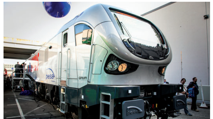
Električna lokomotiva za 3 kV istosmerni tok Gama Marathon najstarejše-ga poljskega proizvajalca železniških vozil PESA z močjo 5.600 kW
