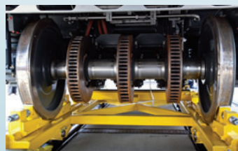
Podvozje vlaka. Zaradi različne tirne širine so Desiro RUS postavili na posebne podstavne vozičke (foto: Miško Kranjec)
