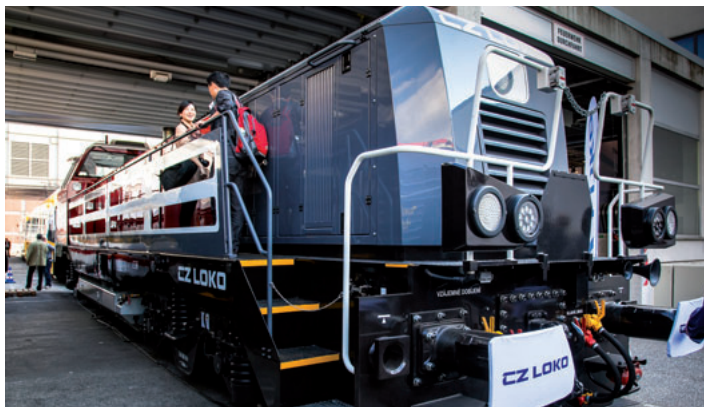
Dizel-električna lokomotiva češke tovarne CZ Loko z močjo 1.450 kW za delo na premiku in lokalnih progah
