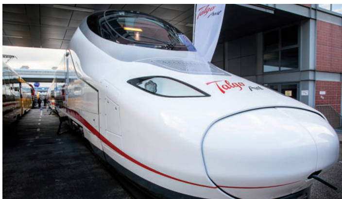
Prototip novega vlaka Talgo Avril, ki dosega hitrost 380 km/h, lahko pelje 600 potnikov, izdelovali pa ga bodo za tirne širine 1.435 mm, 1.520 mm in 1.668 mm.
