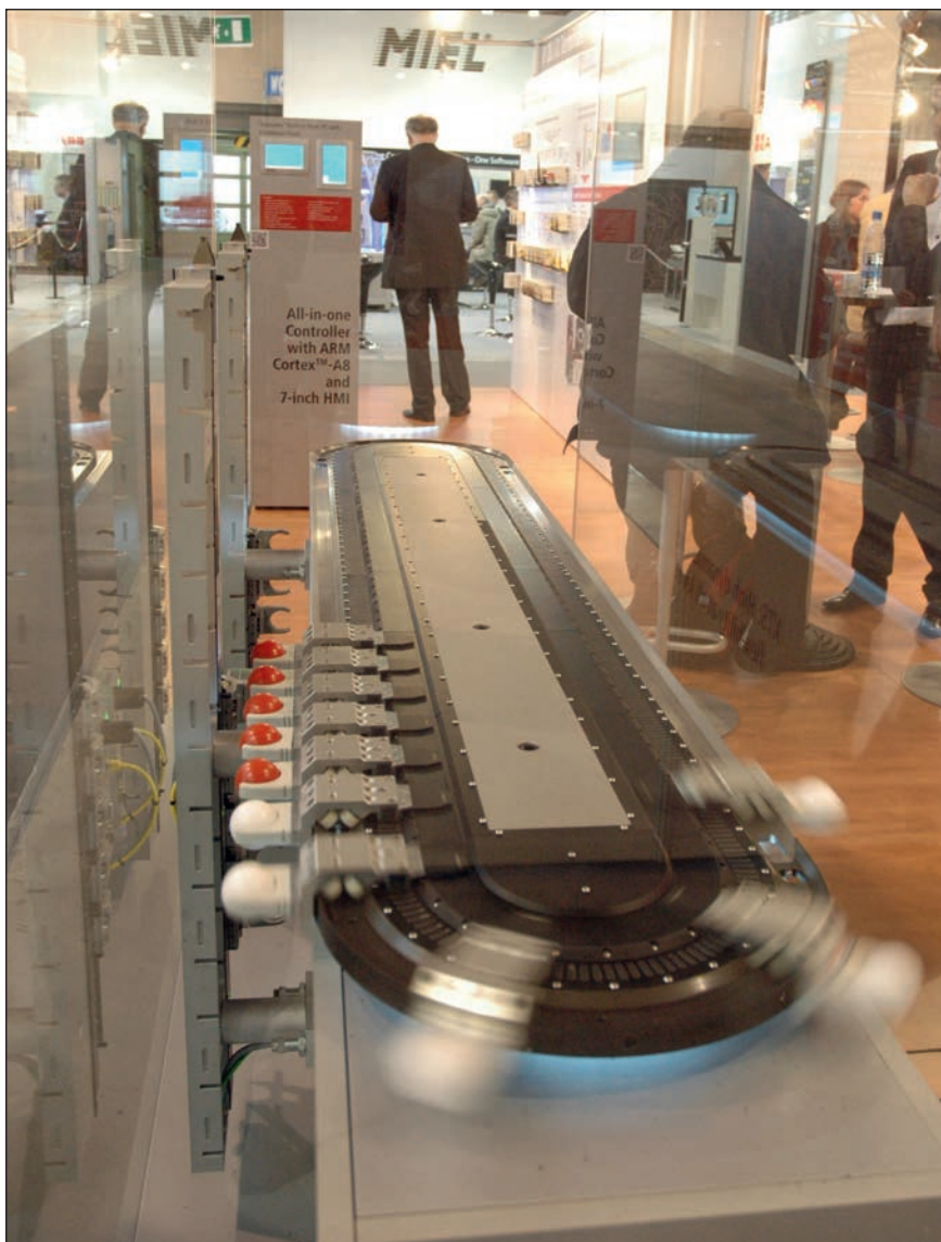
Slika 12. Kombinacija horizontalnega sistema XTS in vertikalnih sistemov – na sliki je prikazan demo sistem s sejma IFAM 2015 – je odličen način za izločanje določenih elementov iz proizvodnega toka in njihovo razvrščanje glede na izbrane kriterije
