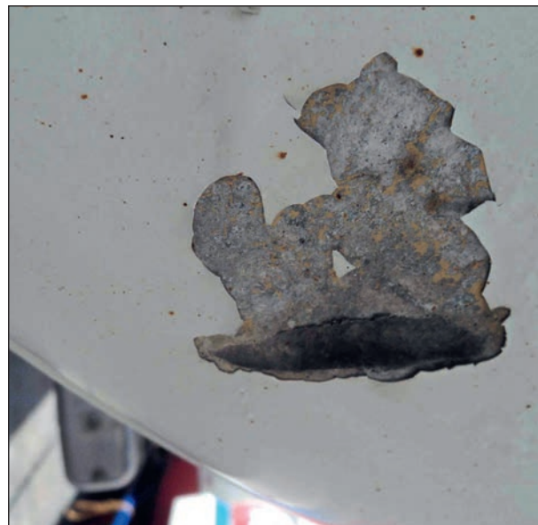
Slika 1. Plastična deformacija na dnu cisterne
