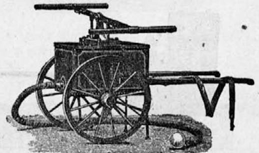
Dvokolna brizgalnica, podvojeno brizgajoča 180–200 2 /min.
