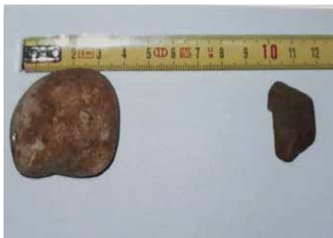
Slika 2: Kamni v sprinkler cevi
