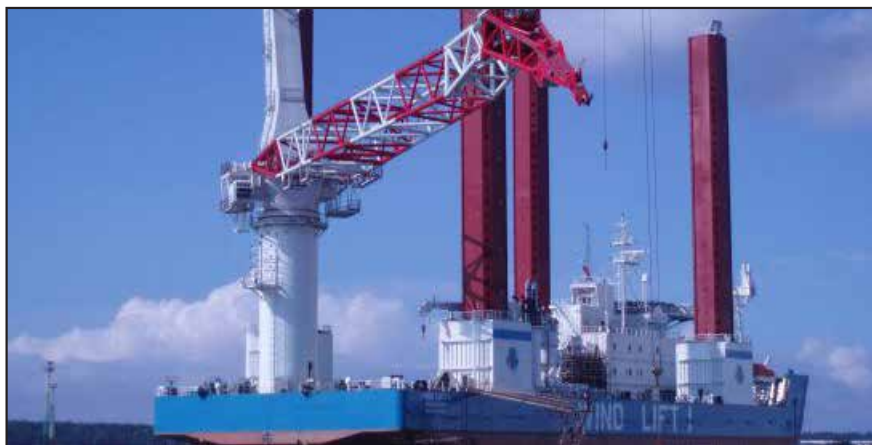
500-tonski žerjav za postavitev vetrnih elektrarn, HYCOM je dobavil kompletno hidravliko in elektroniko za krmiljenje
