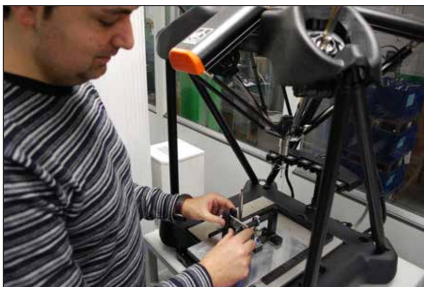
Slika 3. Inženir pri Eponsi vloga mehanizem brisalca v merilni sistem Equator
