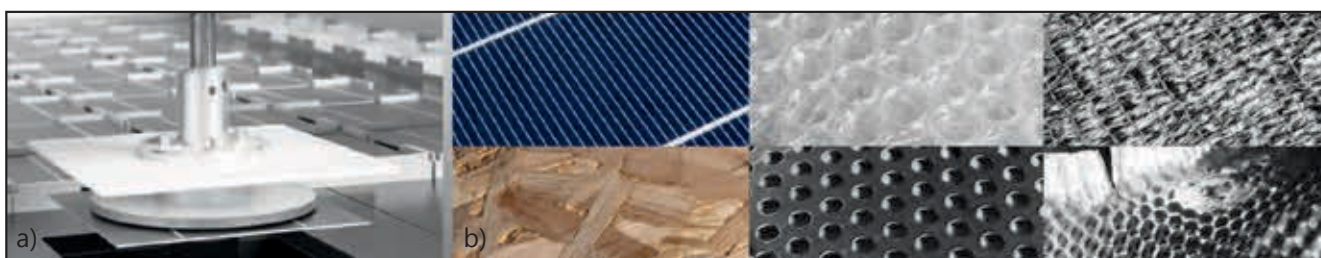
Slika 2. Prijemalo pri prijemanju (a) in različni materiali prijemancev (b)
