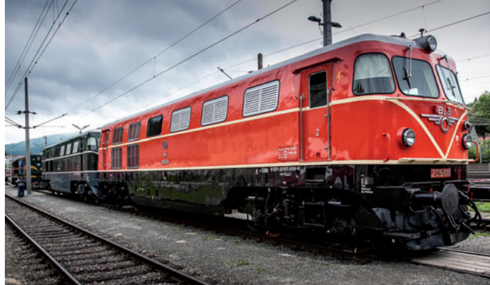
Oblika je drugačna, a v notranjosti avstrijskih lokomotiv 2050 bije enako srce – dobri stari GM agregat 567
