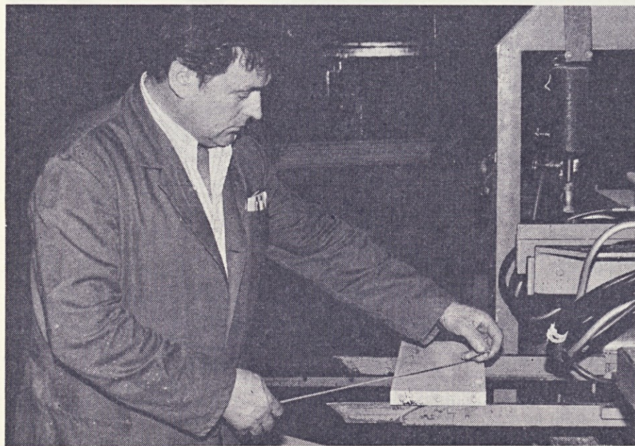
Tone Jeglič je k vrtanju lukenj za moznike na mozničarki in zabijanje moznikov v strope omaric pisalnih miz dodal še vrtanje lukenj za unit matice. Inovacija je uspela. Prej tri operacije so sedaj na mozničarki napravljene naenkrat.
