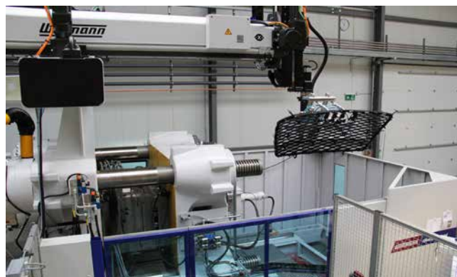
» Slika 2: Robot WITTMANN W843 odstranjuje izdelek iz stroja MacroPower 1500/8800.
