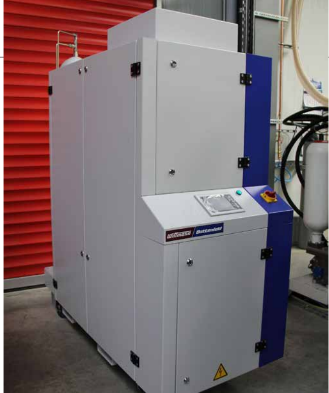
» Slika 3: Tlačni generator WITTMANN BATTENFELD za proces vbrzganja plina AIRMOULD® in proces penjenja CELMOULD®
