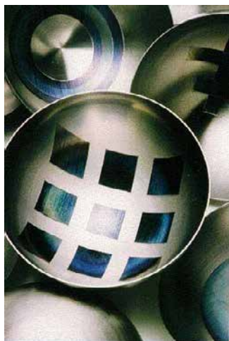
» Slika 1: a) Lasersko označena skleda iz niobija in b) lasersko narajen barven metulj na kovini. [2]
