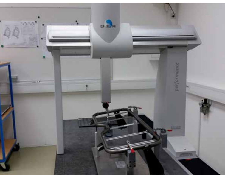
» Merjenje jeklenega ogrodja sedeža s KMS Hexagon Metrology DEA GLOBAL Silver Performance. Položaj potnikov v sedežih se določa po strogih varnostnih standardih z roko ROMER Absolute Arm na lutkah, ki sedijo v vozilu.
