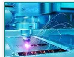
181 Lasersko rezanje debelejšega nerjavnega jekla z diodnimi laserji visokih moči
