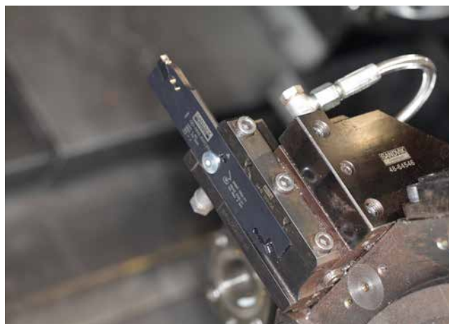
» Koncept za globoko odrezovanje CoroCut QD omogoča intenzivno uporabo visokonatančnega dovoda hladilne tekočine pod tlakom
