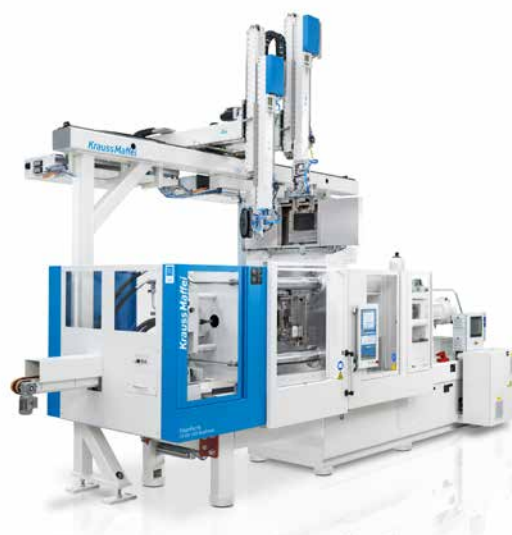
» Slika 2: Avtomatizacija, integrirana v zaščitno ohišje stroja pri CX 300 FiberForm, zmanjšuje potreben prostor za proizvodnjo za do 40 odstotkov.
