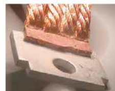
Spajanje pletenih kablov
