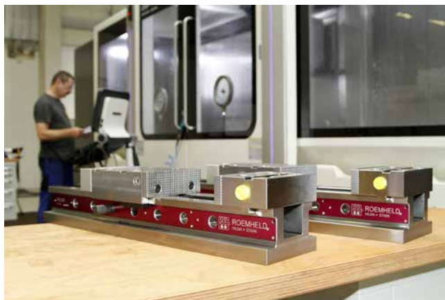
» Slika 2: Zaradi serijske mere podstavka 750 mm je vpenjalno območje primeža, ki znaša 508 mm za velike obdelovance v glavnem ustrezno. Za razširitev pa obstajajo različni čeljustni vpenjalni nastavitvi s pomočjo katerih lahko vpenjalno območje povečamo na maksimalno 772 mm
