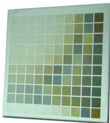
» Slika 4: Uporaba pulzne vnosu toplote z višjo frekvenco pri vlakenskih laserjih lahko dosežemo neverjetno barvno paleto na nerjavnem jeklu.
