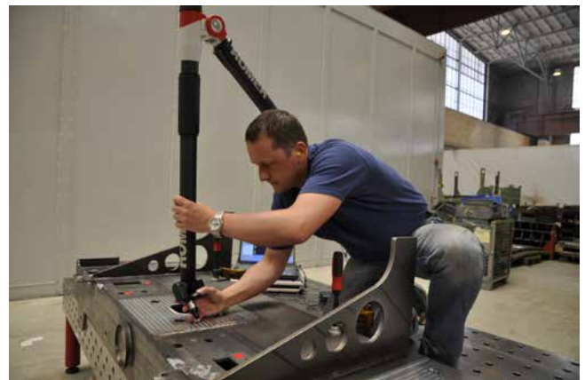
» Dimenzijska kontrola podporne plošče spojke za tramvaj.
