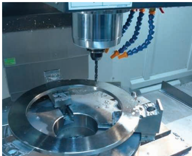
» Slika 2: Serijsko vrtnanje v nerjavno jeklo 1.4462 s svedrom WDO-SUS
