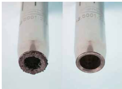
» Varilna šoba z obrizgi pred čiščenjem (levo) in po čiščenju (desno)
