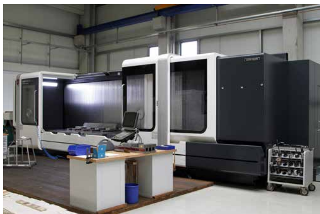
» Od leta 2014 uporabljajo v podjetju UKB v proizvodnji robilnih orodij prvi v Evropo dobavljeni CNC-5-osni linearni frezalni center DMF 600 dobavitelja DMG Mori (Slika: ROEMHELD).
