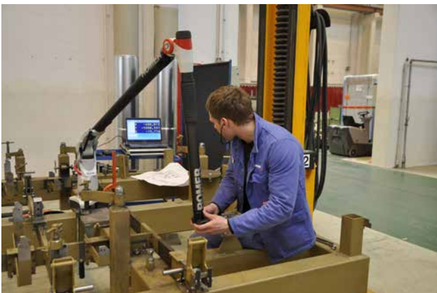
» Z merilnim območjem 4m merilna roka ROMER doseže vse pomebne točke na pripravi.
